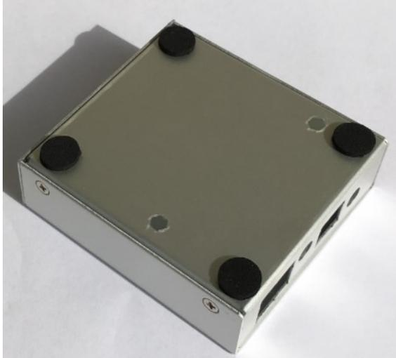
Montieren Sie das ERC-M-Interface mit den M3x6 Schrauben in das Gehäuseunterteil.
