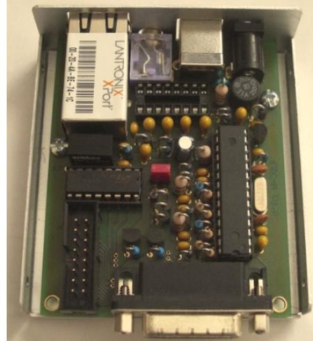
Entfernen Sie die D-SUB-Bolzen und montieren Sie das Gehäuseoberteil mit den D-SUB-Bolzen und den 4 Gehäuseschrauben.
